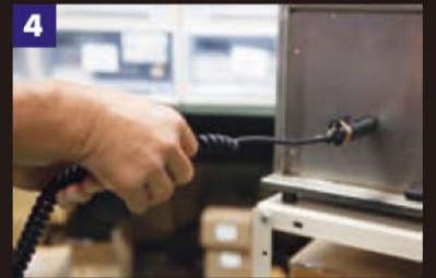
巻きグセがついたケーブルにバネ性をもたせるための作業が「巻き直し」。これを行うことで軽やかに伸び縮みするカールコードになる
