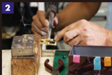
2 プラグにハンダ付けする。人の手が加わる部分ゆえに「慣れるまで相当練習が必要」だという。熟練の技が光る
