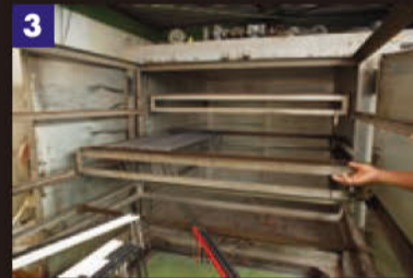
心棒に巻きつけたケーブルを電気釜で熱する。ケーブルの素材や太さに合わせて、10~15分、120~150℃の熱を加える
