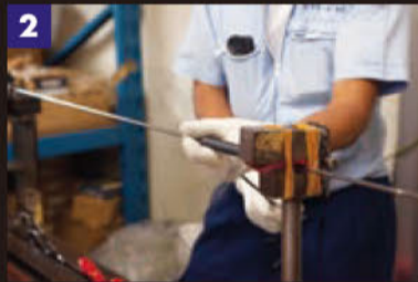
ケーブルを心棒に巻きつけていく。均一に、緩みなく巻きつけるには、熟練の技が必要だ。社内でも数人しか行なえないとか
