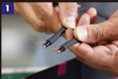
1 ケーブルの皮膜をむき、シールド部を処理する。内部構造は製品によりけりで、ここでの処理が雑だと、音にも影響が出る
